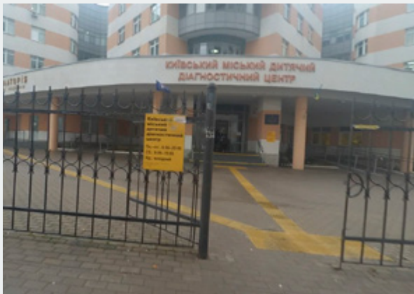
Системи тактильних смуг повинні бути передбачені по усіх шляхах руху на прилеглий території від входу на земельну ділянку до входів до об'єктів, будівель та споруд громадського призначення
